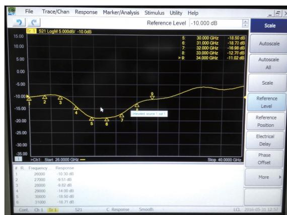
图 11 基于薄膜电阻的波导 E-T 结的  $S_{32}$  实测结果
