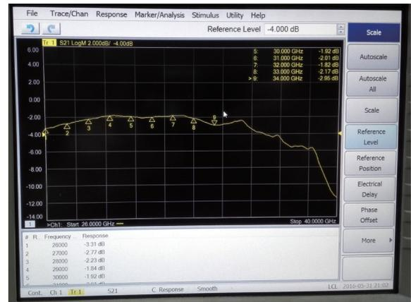
图 14 基于薄膜电阻波导 E-T 结的八路功率合成网络实测结果
