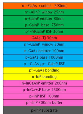
图5 键合三结太阳电池结构示意图
