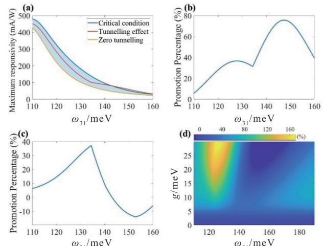
图4 光电响应最大值与隧穿效应及临界耦合条件的关系分析:(a)  $g = 11$  meV时,不同条件下光电响应率最大值随提取能级  $\omega_{31}$  的变化:蓝色实线表示考虑隧穿效应并满足临界耦合条件的结果,橙色实线表示仅考虑隧穿效应的结果,红色实线表示忽略隧穿效应的结果;(b) 考虑隧穿效应相对于未考虑隧穿效应的光电响应率提升百分比;(c) 新临界耦合条件相对于仅考虑隧穿效应的光电响应率提升百分比;(d) 改变耦合强度  $g$ ,本文临界耦合条件相对于常规临界耦合条件的光电响应率提升百分比的热图
